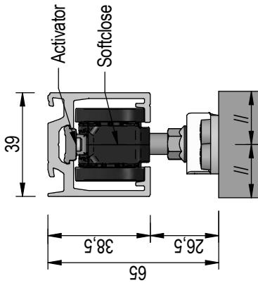
Volgorde van te plaatsen onderdelen in railprofiel. Voor positie activator en ophangplaat zie tekening zie tekening aan achterzijde.
